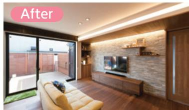
昭和 53 年建築の実家を子世代が引き継ぎ、間取りの変更と同時に、耐震改修を行いました。耐震診断を行った後、耐力壁を適切な位置に増設して、建物全体の耐震性能を向上させました。リビングのタイルで仕上げたおしゃれな壁も実は耐力壁。
