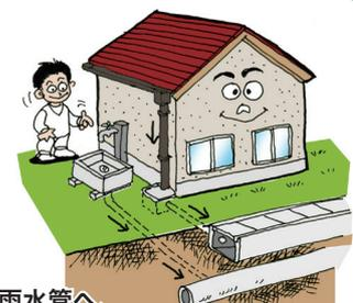
●雨水は雨水管へ、雑排水は下水管に接続する…OK
