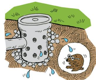
浸透枡による雨水の土壌浸透
