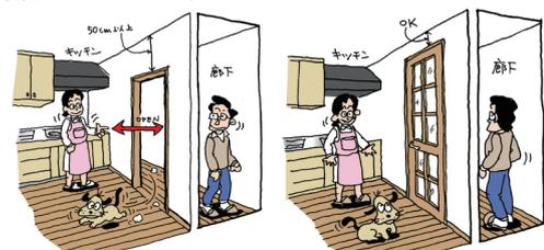
不燃材料でつくるか覆った垂れ壁が必要。扉上部の下り壁に、垂れ壁の規定は適用されない。
