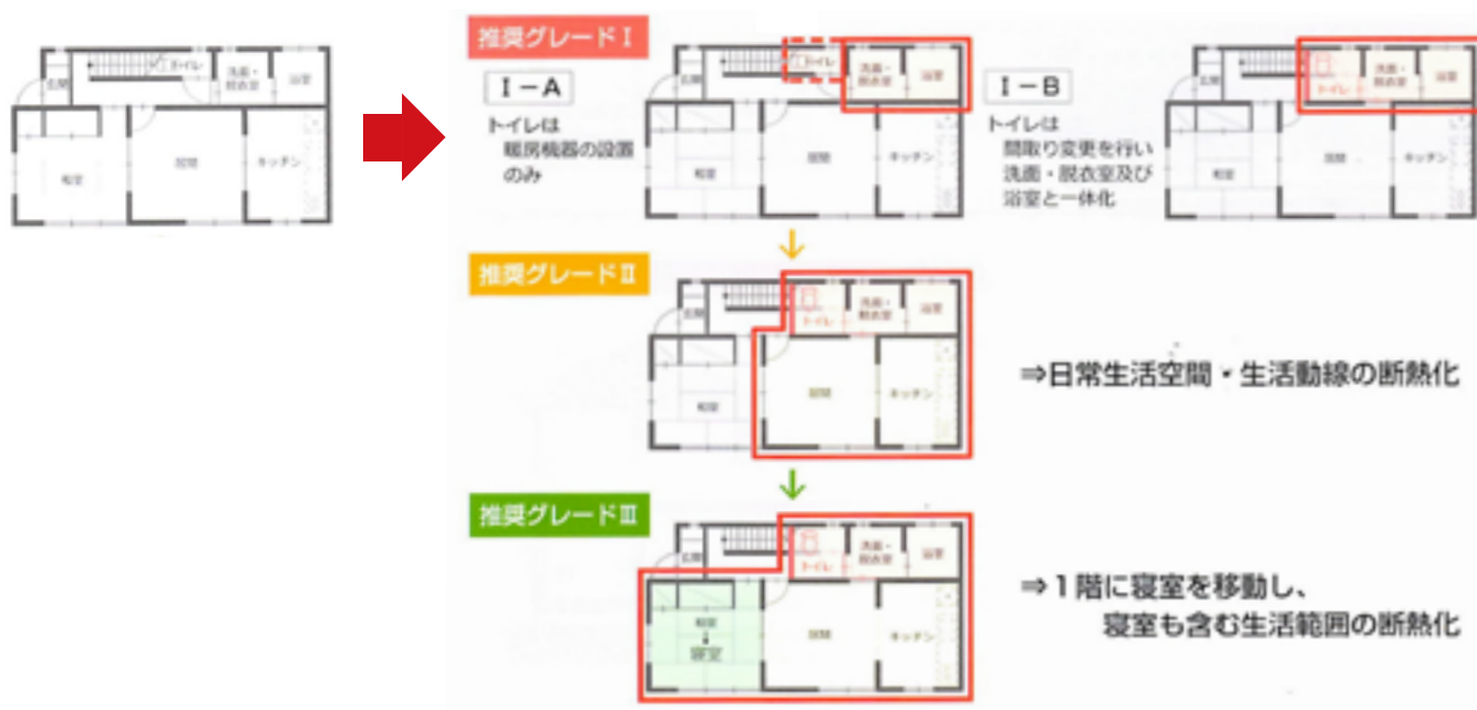
■図 19 部分断熱の考え方③ 暮らし創造研究会「健康で快適な暮らしのためのリフォーム読本」より
